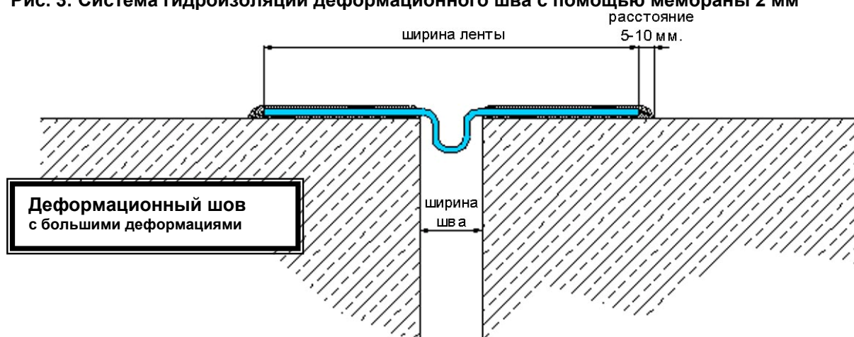
Рисунок 4: Система гидроизоляции деформационного шва при помощи мембраны 2 мм и изготовления петли
