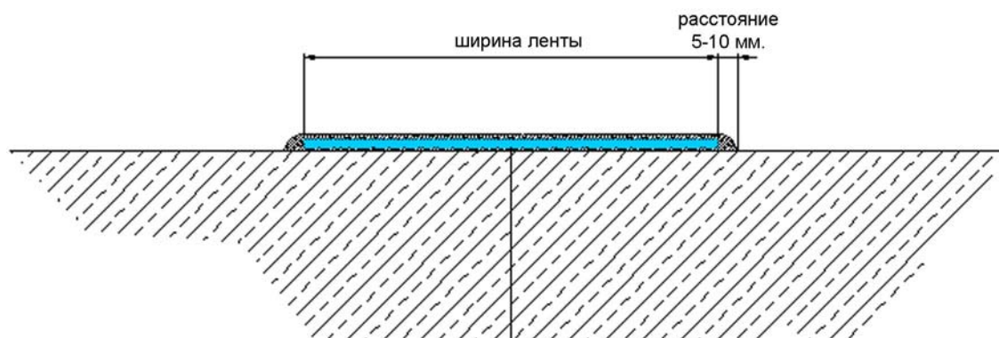
Рисунок 2: Конструкция гидроизоляции рабочего шва с помощью мембраны 1 мм
