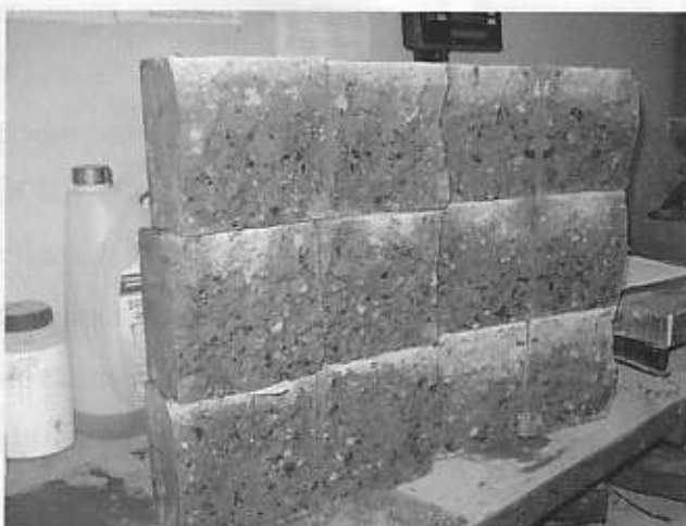
Рисунок 4. Серия образцов основного состава, расколотая на прессе после снятия со стенда водонепроницаемости
