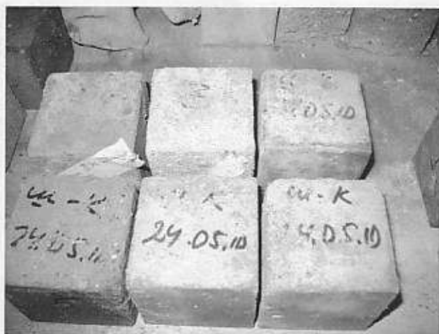
Рисунок 5. Серия образцов контрольного состава после испытаний на морозостойкость (8 циклов)
