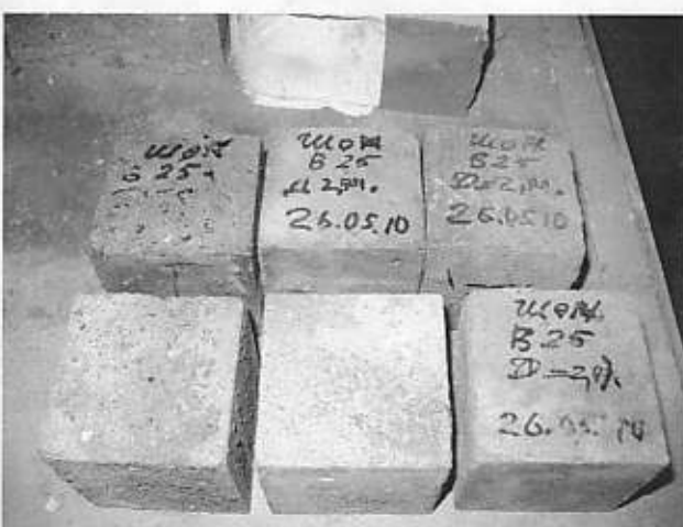
Рисунок 6. Серия образцов основного состава после испытаний на морозостойкость (8 циклов)
